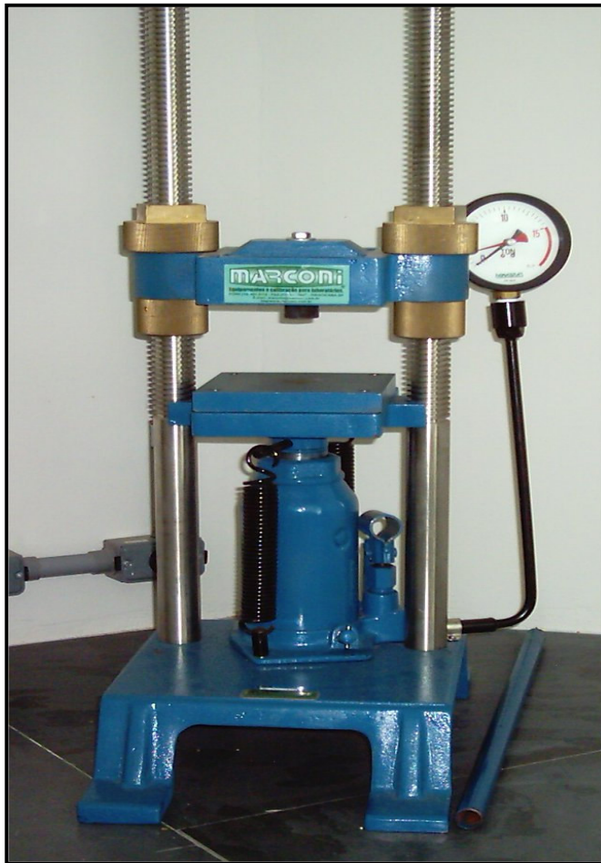
Figura 4.4 – Prensa hidráulica uniaxial manual (Marconi MA 098/A) Fonte: Laboratório de materiais cerâmicos da Universidade Federal de Itajubá.
