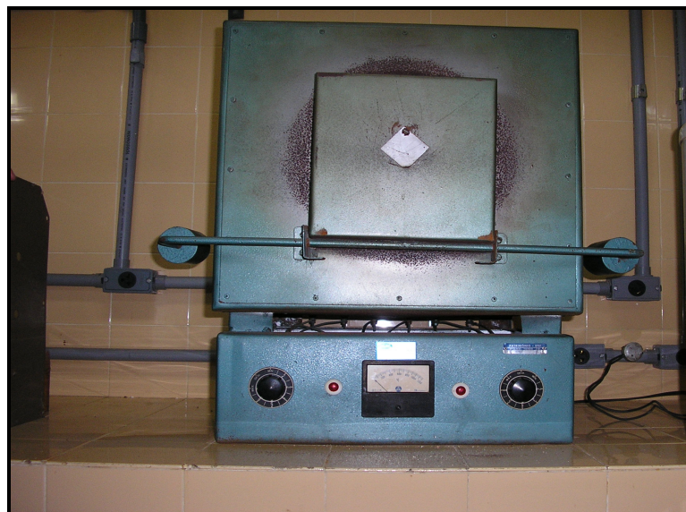
Figura 4.7 – Forno elétrico tipo Mufla (15x 15 x 25) para temperaturas até 1200 °C. Fonte: Laboratório de materiais cerâmicos da Universidade Federal de Itajubá.
