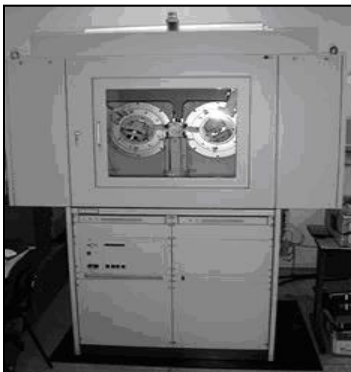
Figura 4.9- Difratômetro de raio x utilizado para análise da estrutura cristalina nas ferritas de galáto de magnésio
