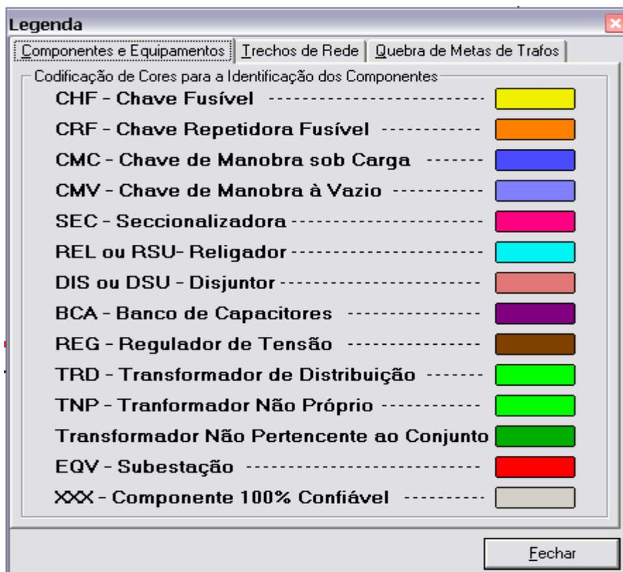
Figura 33 – Tela de apresentação da legenda de cores dos componentes da rede elétrica.
