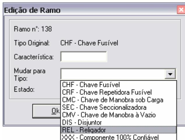
Figura 39 – Tela obtida pelo pressionamento do botão esquerdo do “mouse” sobre o botão ‘Editar’, da figura 38, para modificação do tipo do componente.
