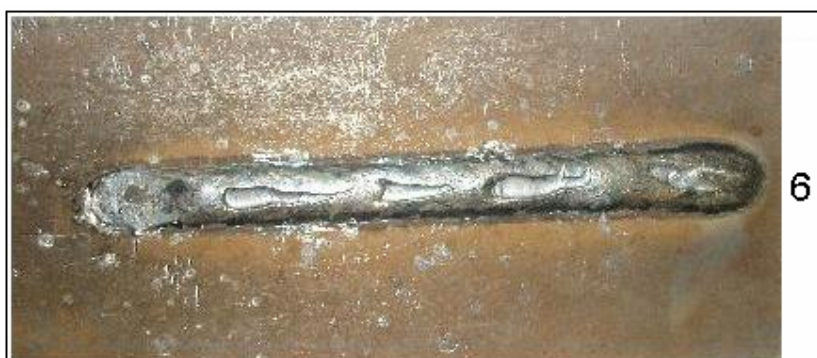
Figura 4.3 – Defeito superficial representado por uma porosidade alongada.
