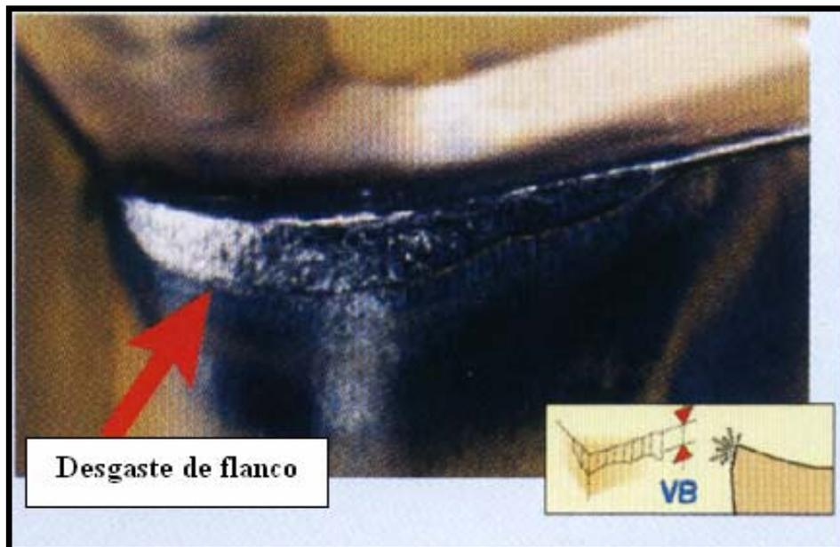
Figura 2.9 – Desgaste de flanco na aresta de corte (Adaptada Sandvik, 2005).
