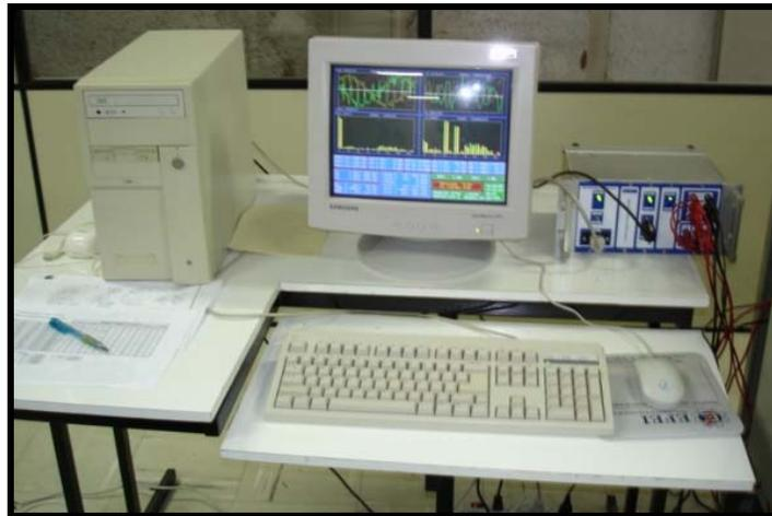
Figura 6.2 - Sistema de monitoramento da potência elétrica consumida.
