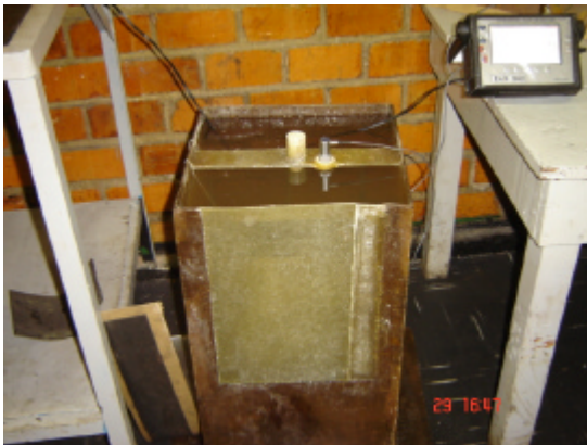
Fig. 5.12 (a) – Detalhes do tanque com HCl. Fig. 5.12 (b) Transdutor acoplado à Alumina.
