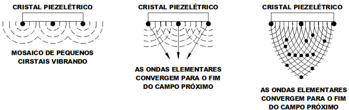
Figura 3.2 – Geração de ondas ultra-sônicas a partir de um cristal piezoelétricos.
