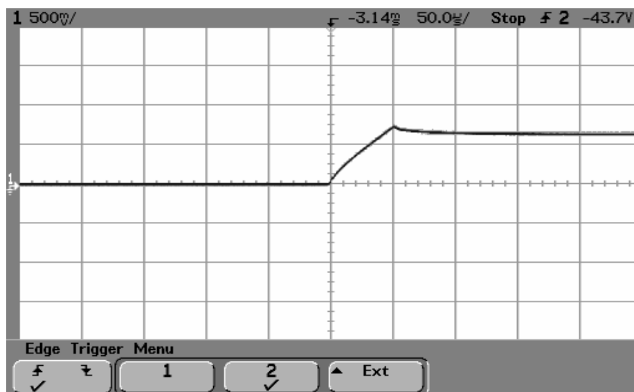
Figura 5.10 - Subida da corrente na válvula 1 do conversor convencional. 1 div. Vert. =7[A], 1 div. Hor. = 50 [ \mu s]
