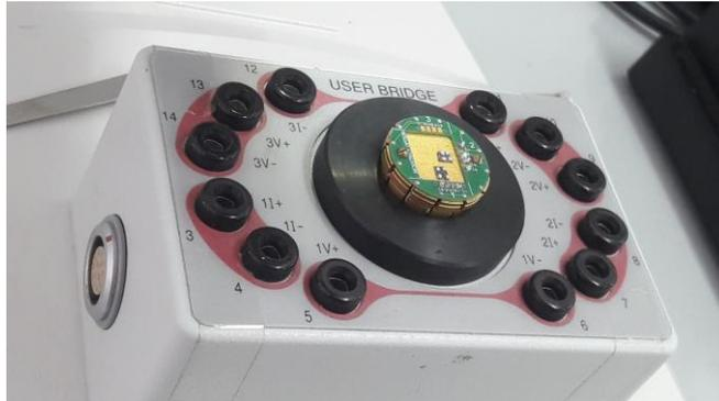
Figura 12 – Porta-amostras com possibilidade de medir até 3 amostras alternadamente.
