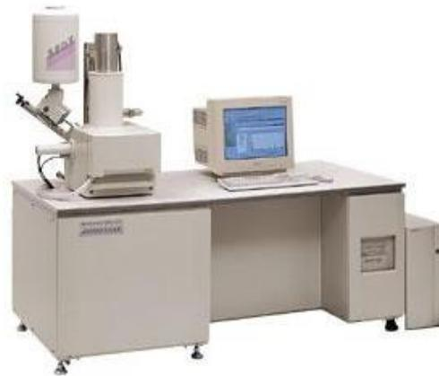
Figura 13 - Ilustração do aparato para realização das imagens de MEV e EDS.
