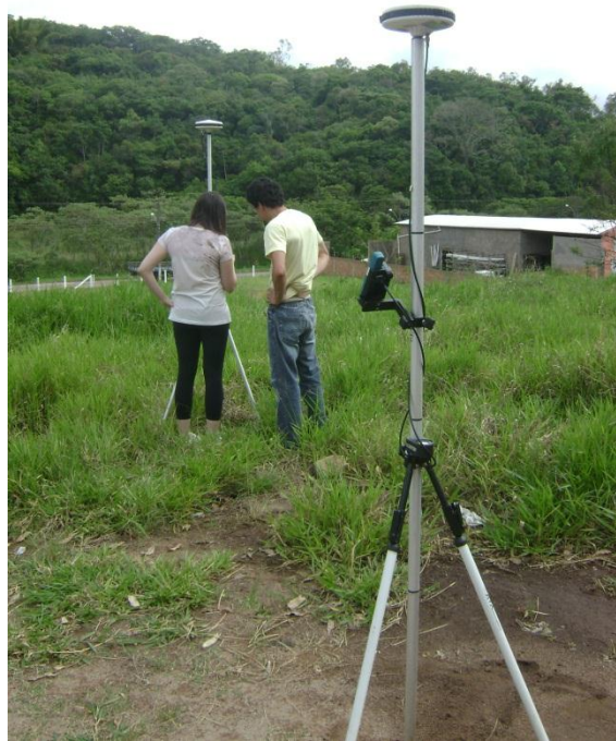
Figura 23– DGPS base e móvel.
