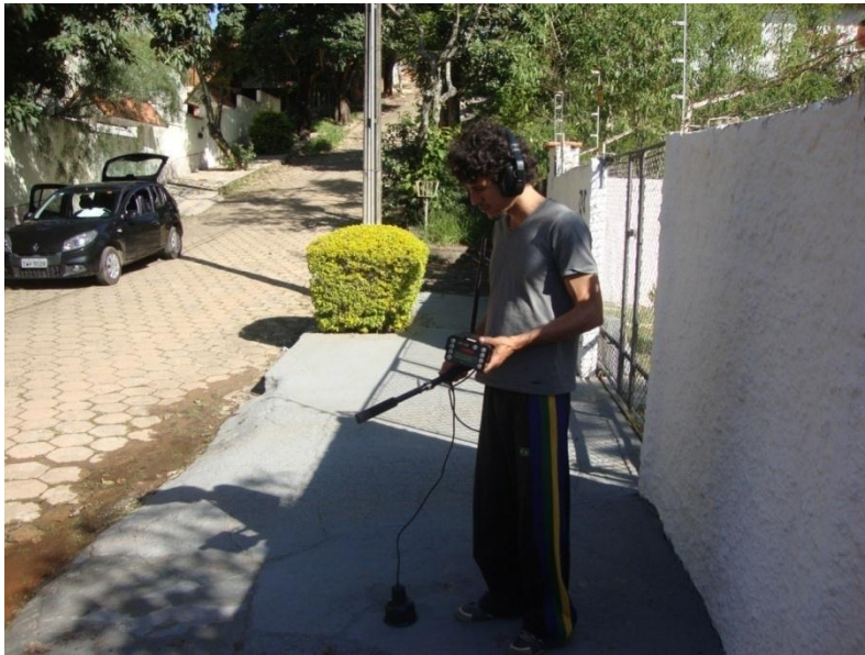
Figura 24 – Uso do geofone na rede em estudo.
