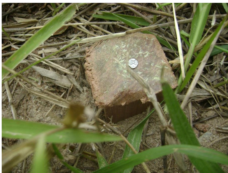
Figura 22– Inserção de uma base (estaca de madeira e prego no centro) na entrada do setor.
