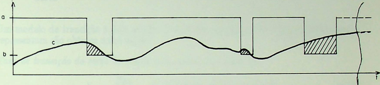
Fig.4.2.3.1 - Influência da Variação da Curva de Cargas (a) capacidade do sistema em condição normal (b) capacidade do sistema durante a contingência (c) curva de demanda
