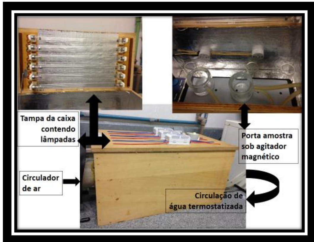
Figura 12: Ilustração esquemática do aparato utilizado nos testes fotocatalíticos [Elaborado pelo autor].
