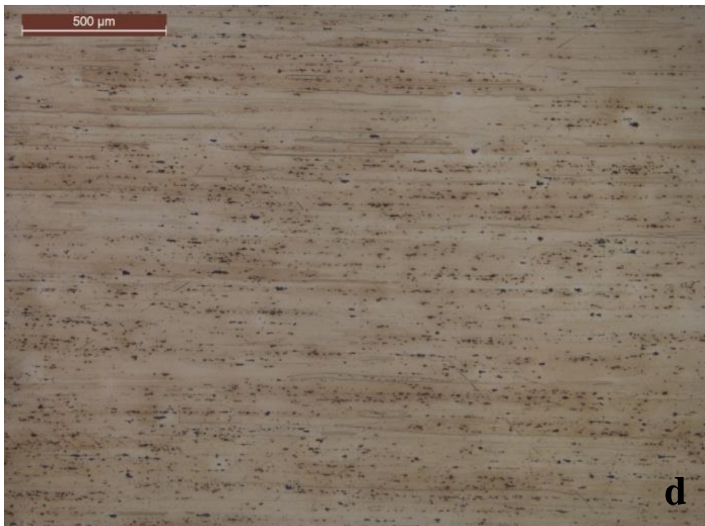
Figura 33: Micrografias de amostras solubilizadas e envelhecidas, 10% laminação. a) envelhecimento por 2h b) envelhecimento por 4h c) envelhecimento por 6h d) envelhecimento por 8h. Ataque Keller por 5 segundos.
