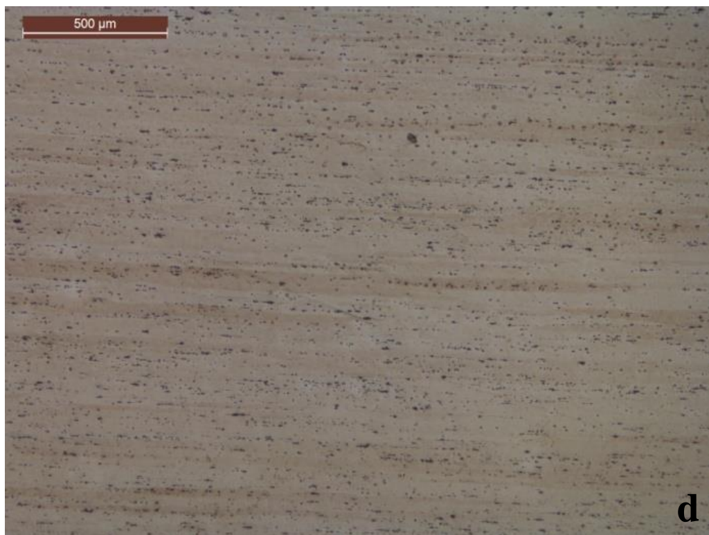
Figura 35: Micrografias de amostras solubilizadas e envelhecidas, 30% laminação. a) envelhecimento por 2h b) envelhecimento por 4h c) envelhecimento por 6h d) envelhecimento por 8h. Ataque Keller por 5 segundos.
