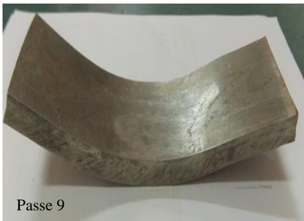
Figura 27: Laminação de uma amostra da liga 2024 e o seu comportamento durante as sequências de passes.
