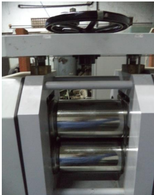
Figura 22: Laminador da marca Coelho do Laboratório de Materiais da Universidade Federal de Itajubá.
