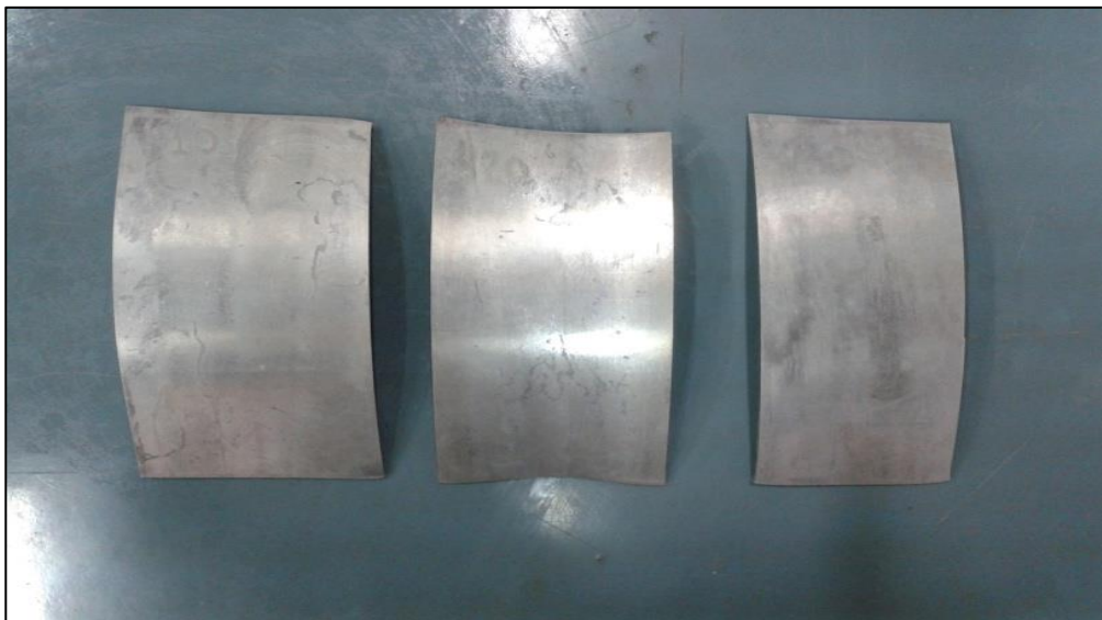
Figura 29: Características das amostras após laminação (60% de redução).
