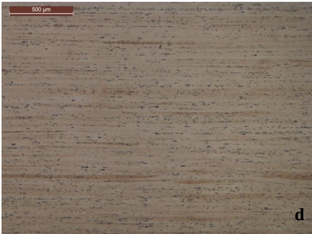
Figura 36: Micrografias de amostras solubilizadas e envelhecidas, 40% laminação. a) envelhecimento por 2h b) envelhecimento por 4h c) envelhecimento por 6h d) envelhecimento por 8h. Ataque Keller por 5 segundos.
