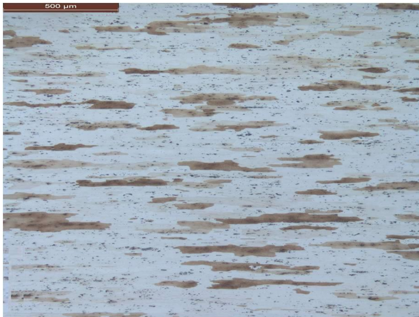
Figura 30: Liga 2024- T351 na condição conforme recebida. Ataque Keller 5 segundos.
