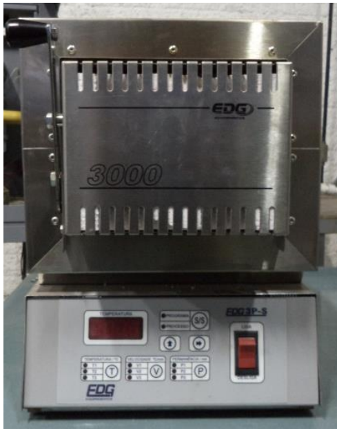
Figura 21: Forno elétrico tipo mufla da marca EDG usado para o tratamento de superenvelhecimento da liga 2024 (Laboratório de Materiais da Universidade Federal de Itajubá).
