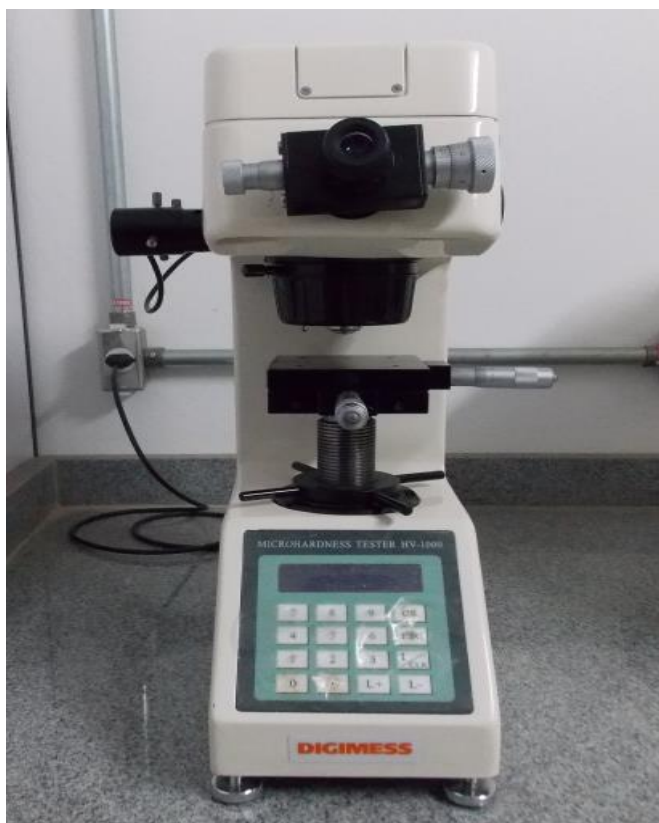
Figura 23: Durômetro Microhardness Tester HV-1000 Digimess usado para a determinação de microdureza vickers (Laboratório de Materiais da Universidade Federal de Itajubá).
