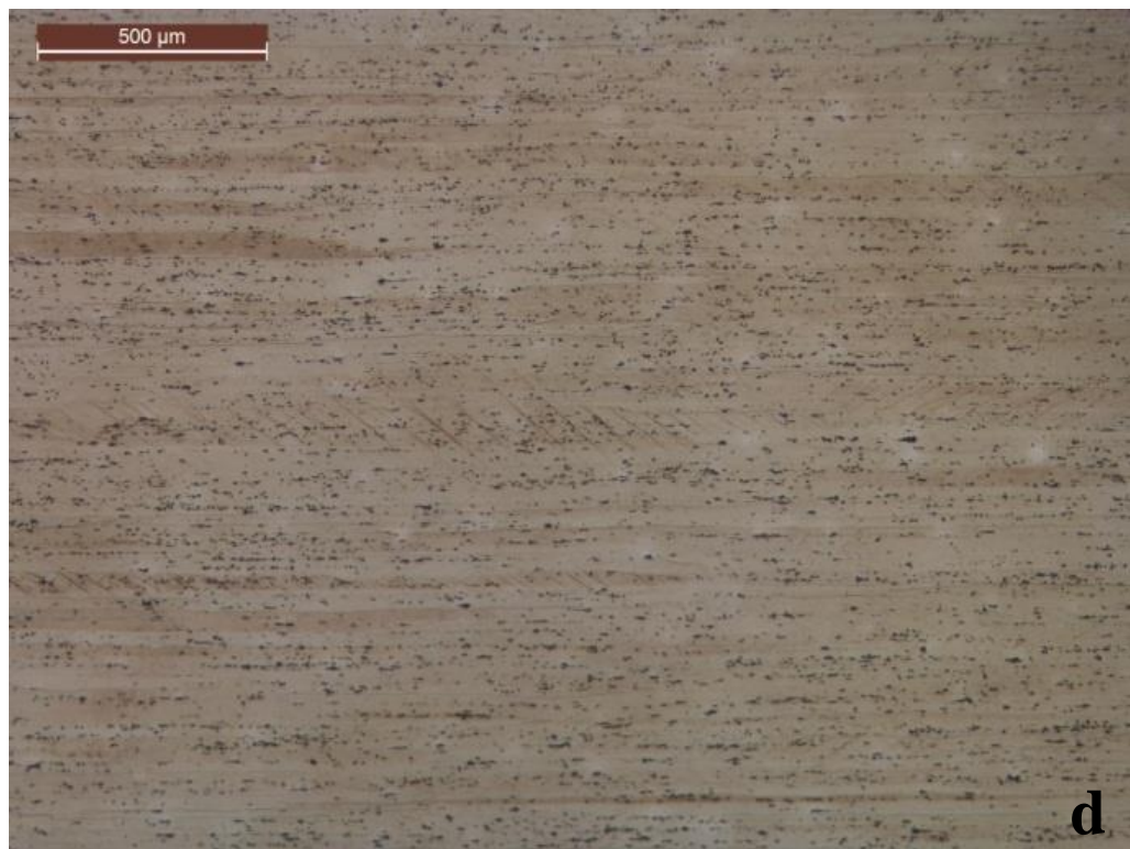
Figura 34: Micrografias de amostras solubilizadas e envelhecidas, 20% laminação. a) envelhecimento por 2h b) envelhecimento por 4h c) envelhecimento por 6h d) envelhecimento por 8h. Ataque Keller por 5 segundos.
