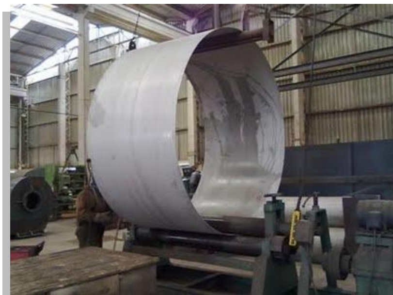
Figura 3-14 – Produção Conduto por calandragem (Fonte: Ideal Ferros)
