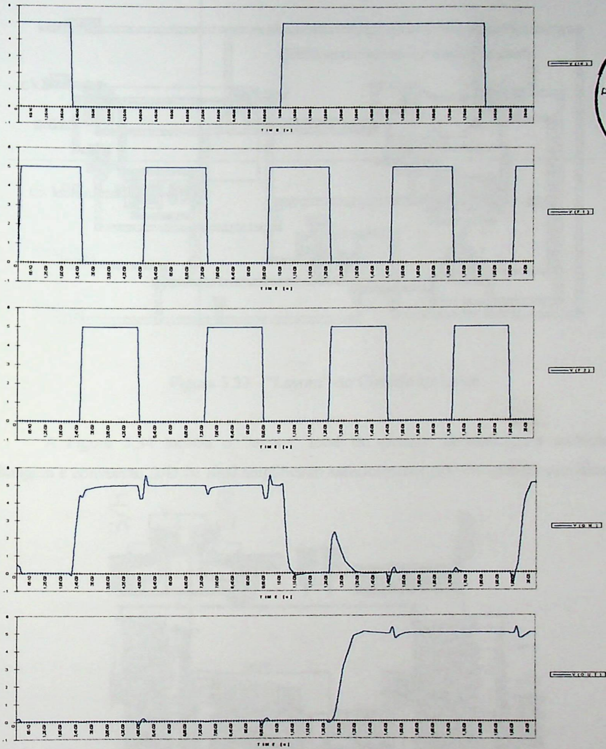
Figura 5.32 - Simulação do Comportamento Dinâmico do Circuito "Latch".
