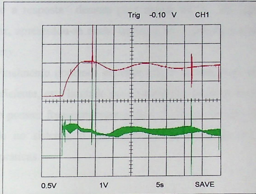
Figura 6.14 Partida com carga para sistema com controle fuzzy 2º Caso
