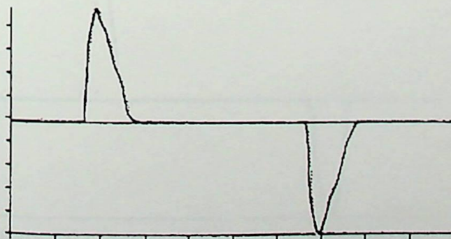
Figura C26 - Forma de onda da corrente de uma lâmpada fluorescente circular de 22 W com reator eletrônico
