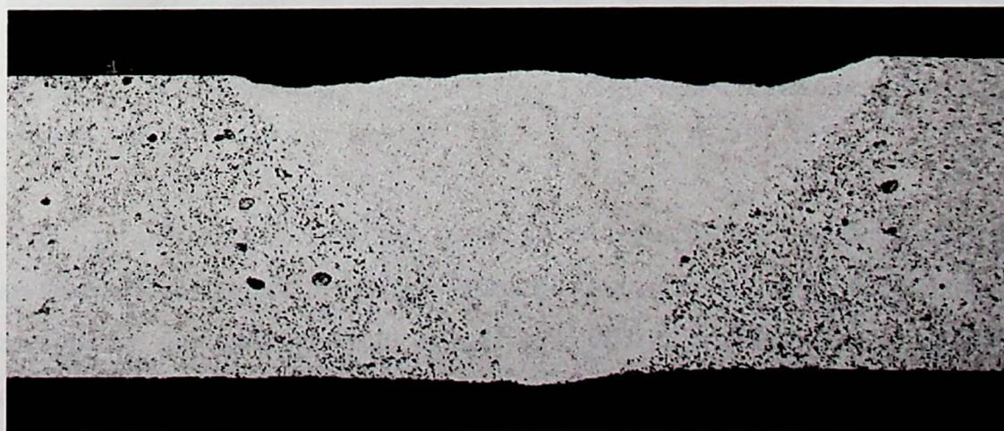
Fig. 4.26- Macrografia da solda da liga Fe-Ni-P de 4 mm de espessura pelo processo Plasma pulsado. Aumento: 8x. Ataque: nital 2%.
