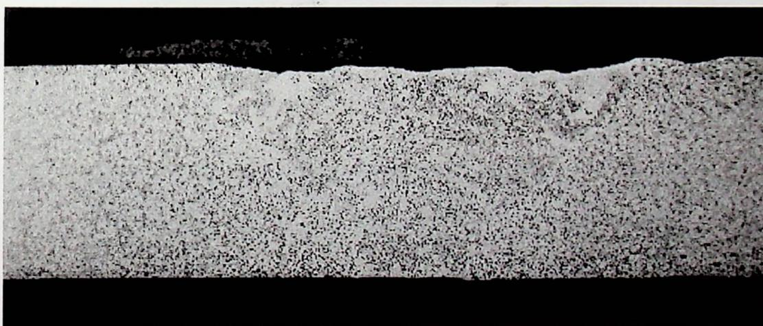
Figura 4.27- Macrografia da solda da liga Fe-Ni de 3 mm de espessura pelo processo Plasma pulsado. Aumento: 8x. Ataque: nital 2%
