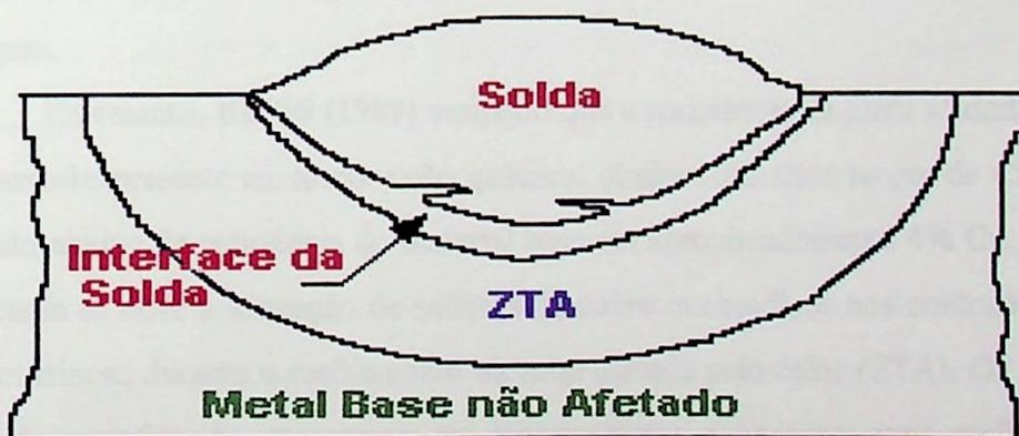
Fig. 2.2- Regiões da junta soldada
