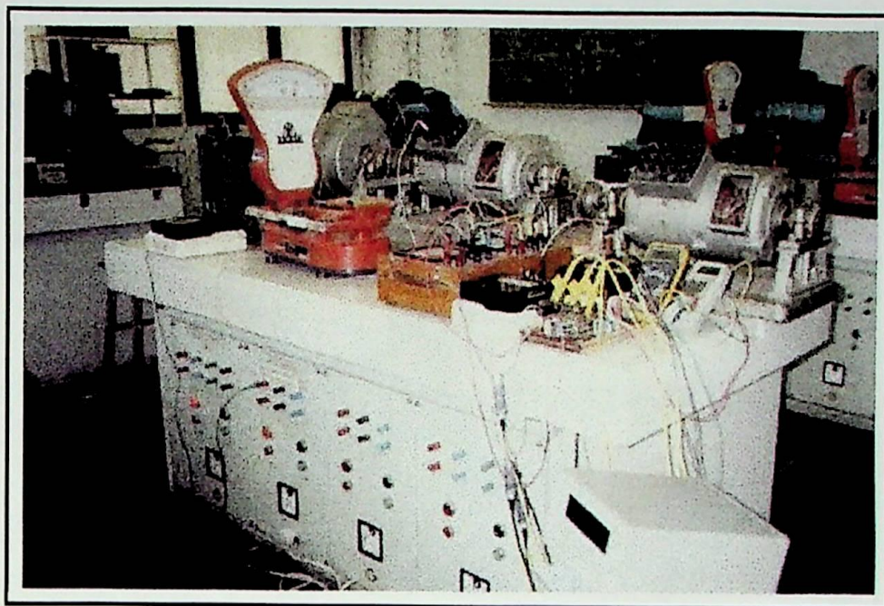
Foto 3: Visão da instrumentação do ensaio do MIT com rotor bobinado
