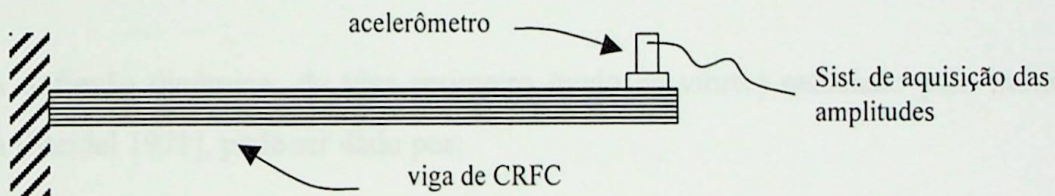
Figura 4.1 – Diagrama esquemático de um corpo-de-prova para ensaio em vibração livre.
