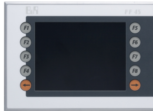
Figura 28: CLP utilizado na identificação e controle dos sistemas de nível. (B&R-AUTOMATION, 2008)
