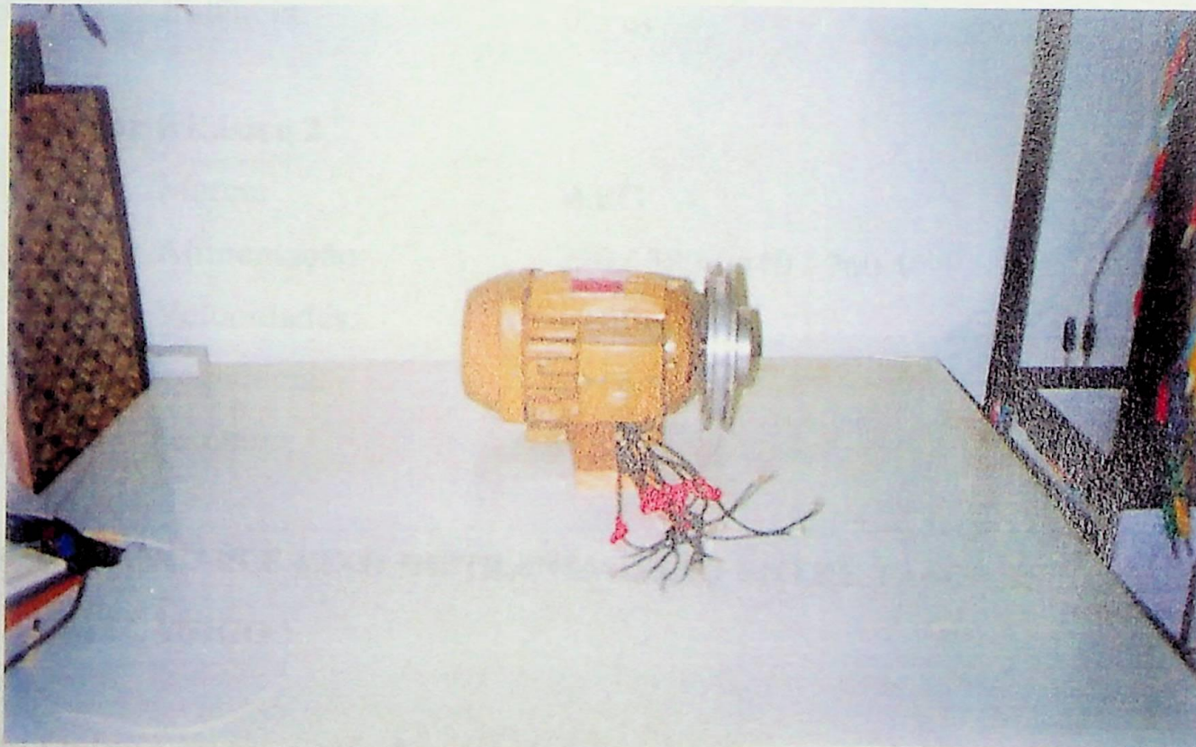
Figura 4.5.2: Motor de indução trifásico de 1 cv
