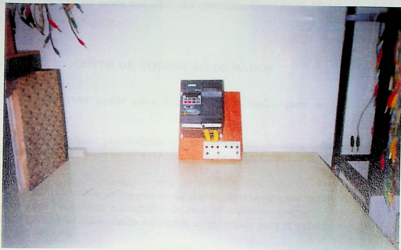
Figura 4.8.1: Micromaster VC de 2 cv marca SIEMENS.
