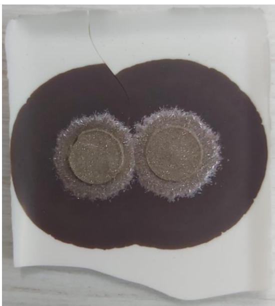
Figura 11: Pastilhas de CCTO 2,90 H 2 sinterizadas a 1150 °C que se aderiram à base de sinterização.
