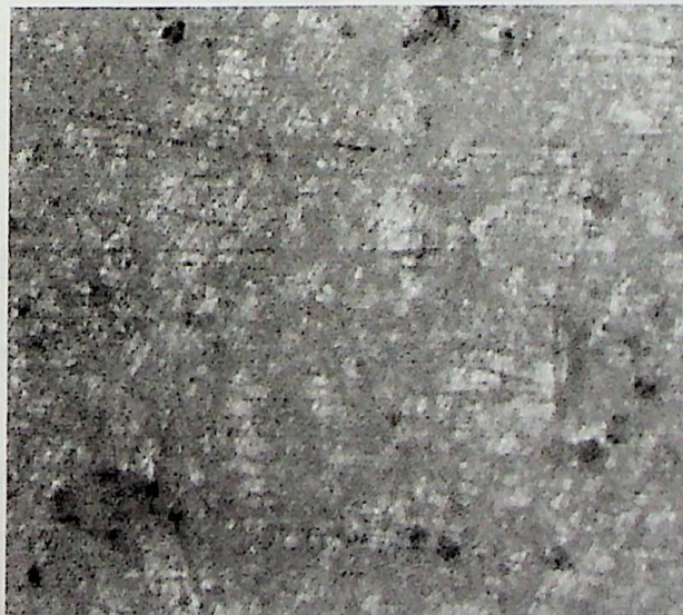
Figura 4.3 – Superfície do corpo de prova após a compactação (Ampliação 160x)
