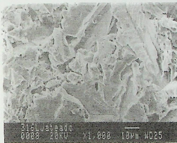
Figura 4.12 - Micrografia do substrato de aço inoxidável AISI 316L para recobrimento.
