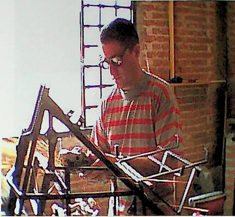
Figura 8.32 – Acabamento final do esmerilhamento do chassis.
