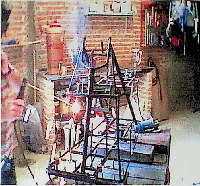
Figura 8.30 – Soldagem do suporte da eletroválvula.
