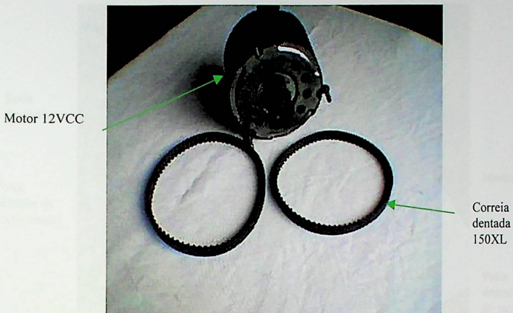
Figura 8.43 – Motor 12VCC utilizado na transmissão do robô.
