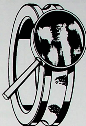
Figura 4.6: Falha na pista interna
