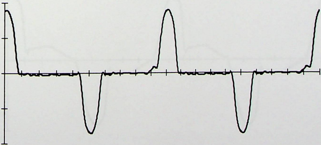
Figura A-10 - Forma de onda reconstituída da corrente do televisor.
