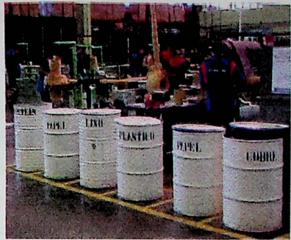
Figura 4.4.6.6 – Tambores para segregação dos resíduos
