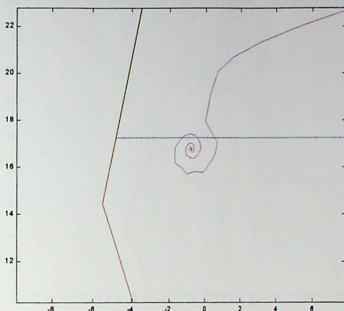
Figura 6.30 – Trajetória da impedância para curto bifásico aplicado a 190 km da SE-MD - Algoritmo recursivo de Fourier
