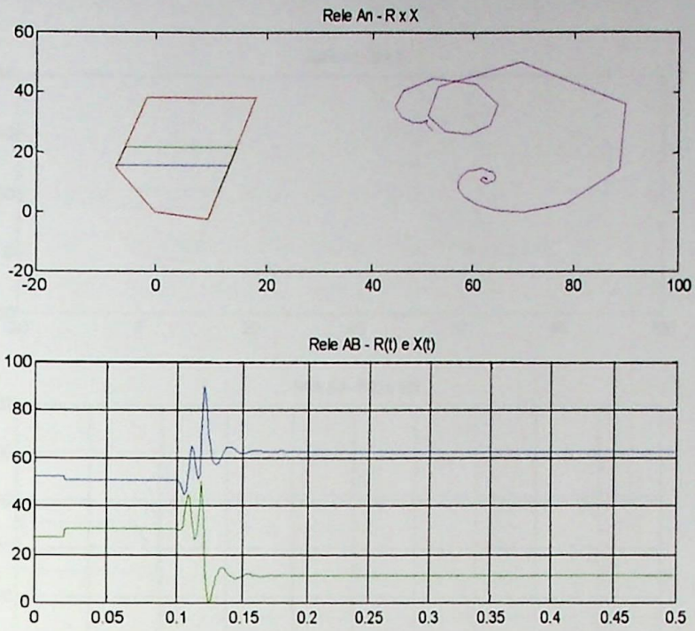
Figura 6.18 – Trajetória da impedância para curto monofásico reverso ao relé - Algoritmo recursivo de Fourier
