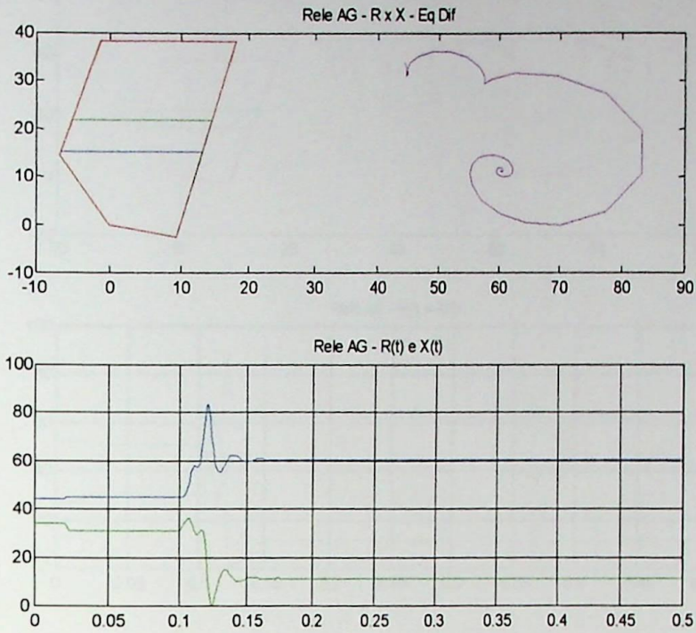
Figura 6.16 – Trajetória da impedância para curto monofásico reverso ao relé - Algoritmo recursivo de Fourier com equação diferencial
