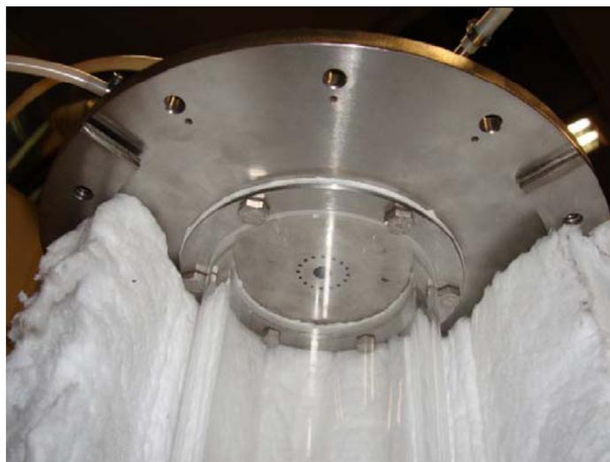
Figura 5.2 Detalhe do posicionamento dos injetores e do revestimento do queimador (VERÍSSIMO, 2011).
