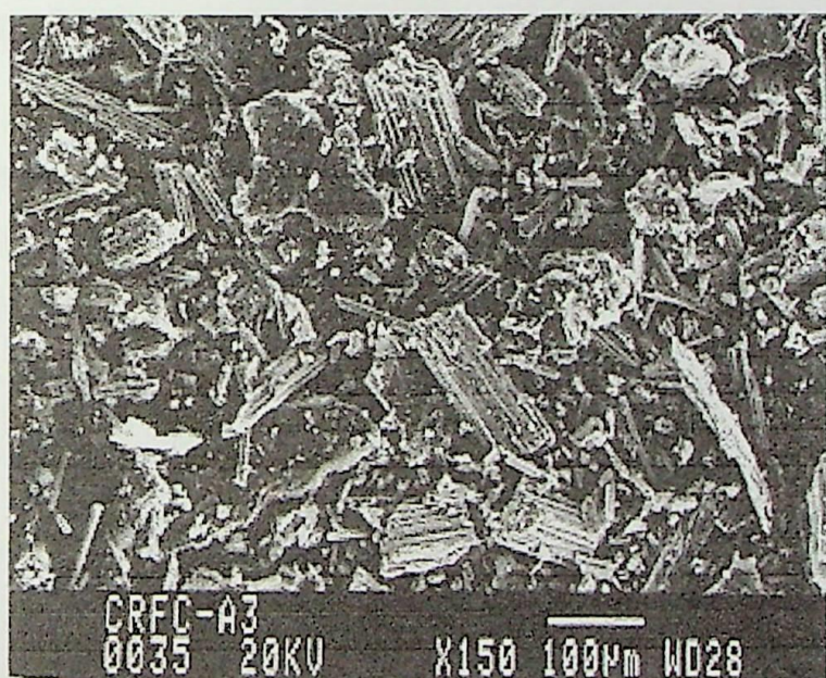
Figura 6.7 – Amostra do cavaco formado no torneamento de compósito C/C. V_c=310 m/min, f=0,12 mm/v, a_p=1 mm, ampliação de 150x.
