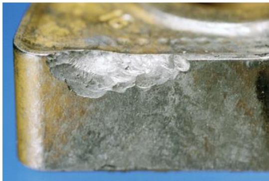
Figura 2.18 - Quebra da aresta de corte (Sandvik, 2013 ).
