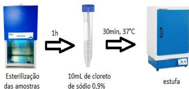
Figura 16: Esquema da preparação das membranas para o ensaio de hemólise.
