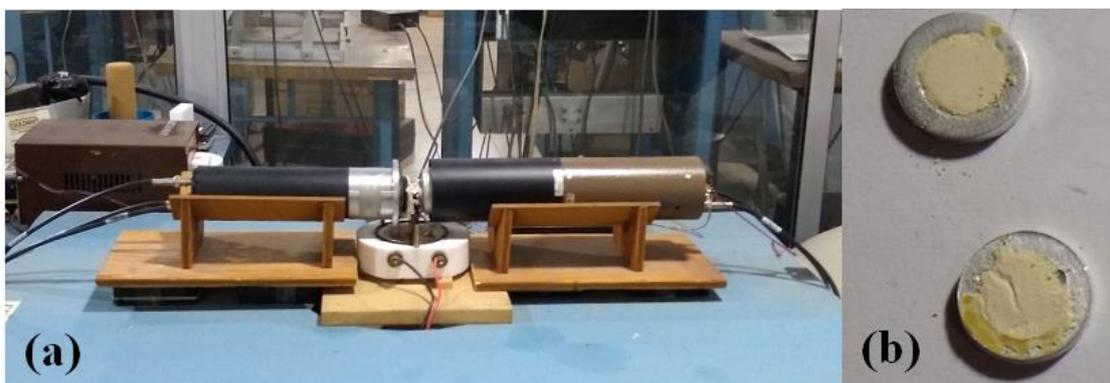
Figura 14: (a) Equipamento utilizado para medidas de PALS; (b) amostra preparada para realizara PALS.
