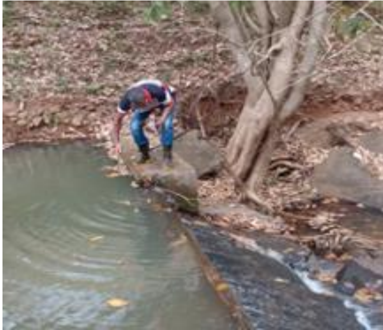
Figura 6 – Vertedor retangular de contração lateral, instalado no córrego Entre Folhas – Minas Gerais Fonte: Autor (2020)
