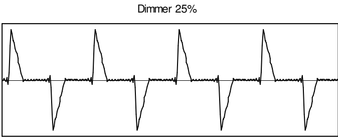
Figura 2.12 - Forma de onda da corrente num dimmer (25%)
