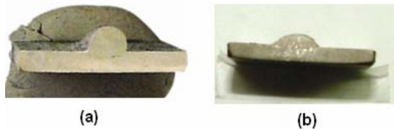
Figura 4.15 – Perfil do cordão de solda com proteção gasosa CO 2 : (a) tensão 19V IND 2 e (b) tensão 23V, IND 9.
