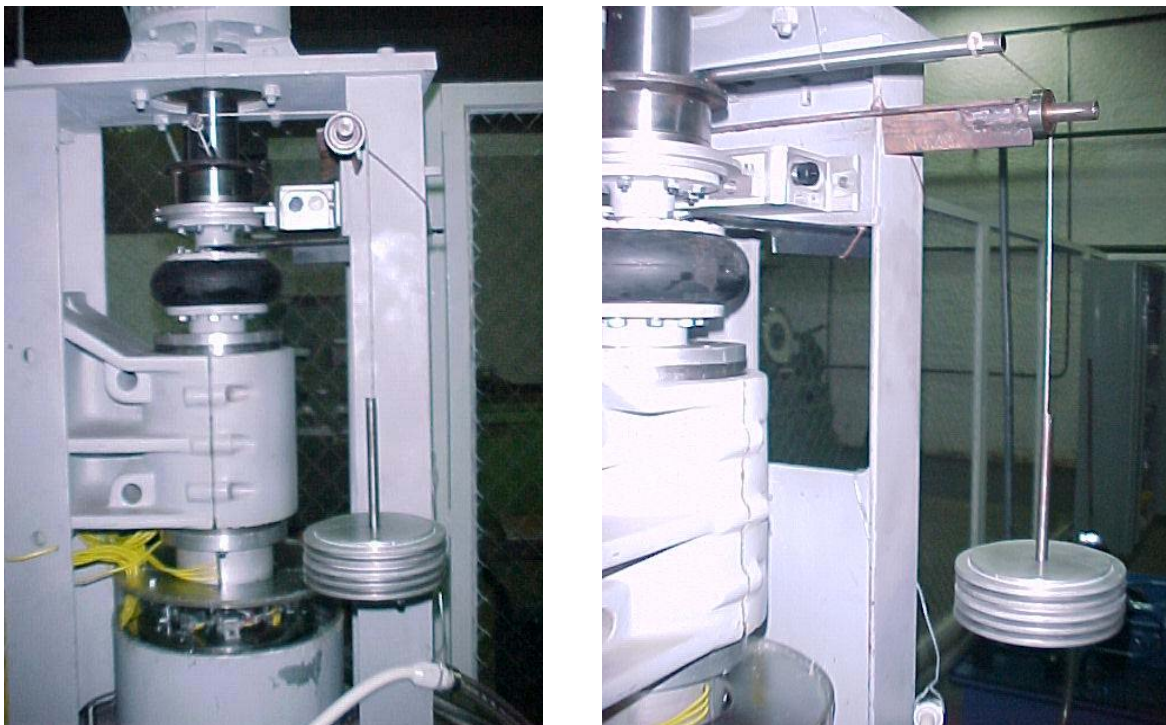
Figura 3.11 – Calibração do Torquímetro.
