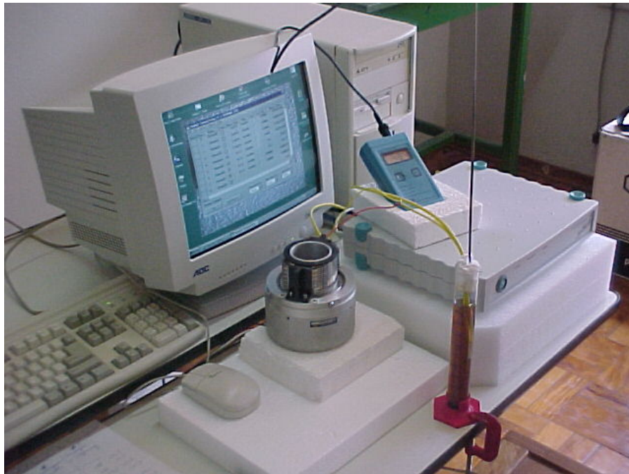
Figura 3.9 – Aferição dos termopares.
