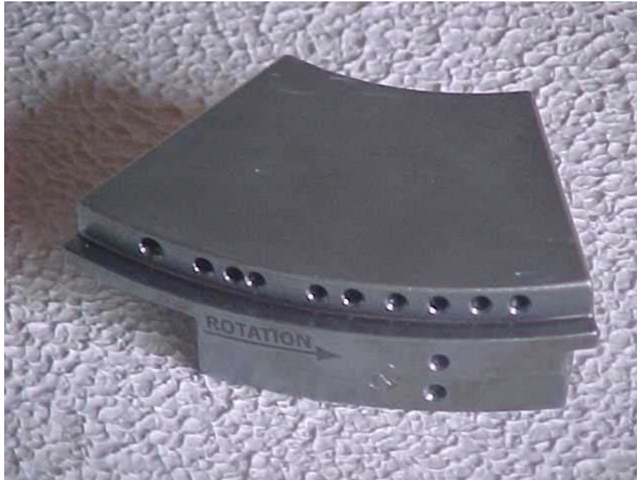
Figura 3.7 – Sapata pivotada a 66%, com furos para inserção dos termopares.
