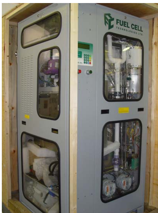
Figura 61 SOFC de 5 kW dos laboratórios do NEST-UNIFEI.
