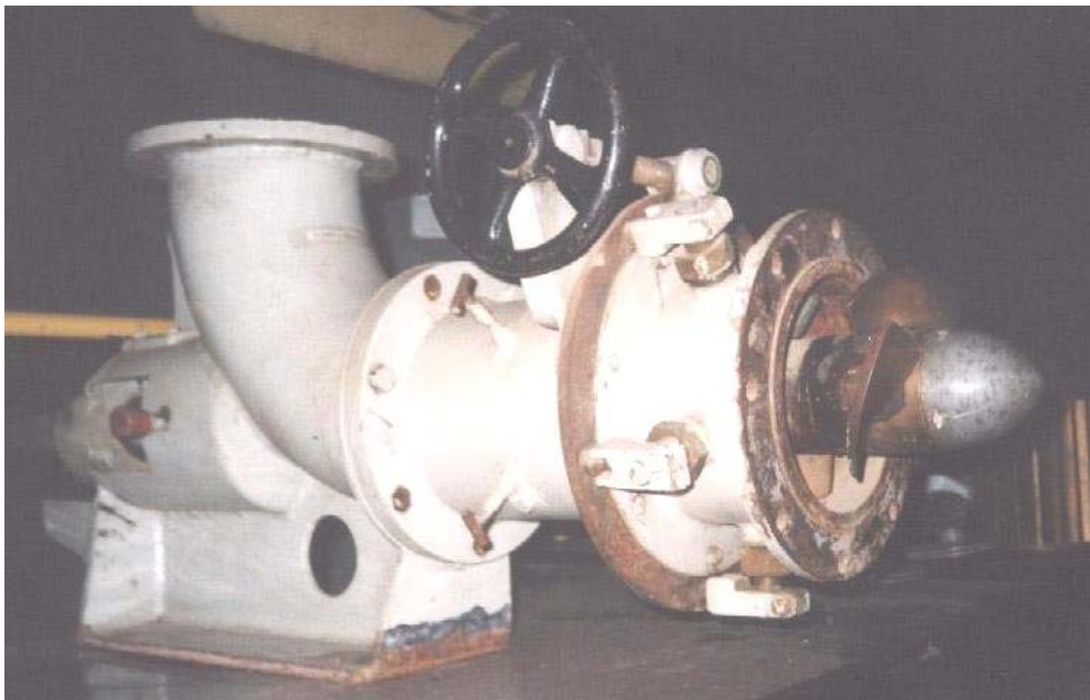
Figura 2 – Modelo reduzido de turbina hélice do tipo tubular, com tubo de sucção desmontado para visualização do rotor (LHPCH – UNIFEI).
