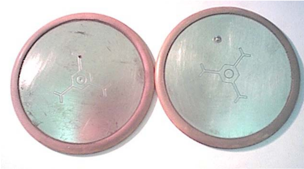
Figura 1.8 - Falha provocada por sobretensão sem a existência de sobrecorrente.
