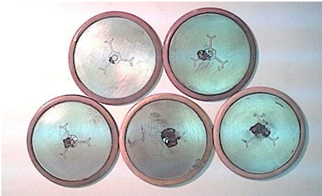
Figura 1.7 - Falha provocada por di/dt elevado.
