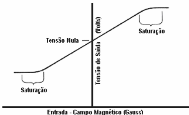
Figura 3.16 – Curva típica de resposta de sensores de efeito hall.
