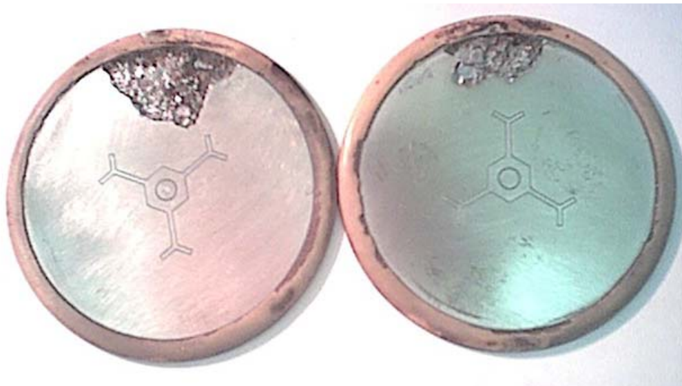
Figura 1.9 - Falha provocada por sobretensão com a existência de sobrecorrente.
