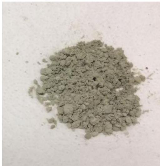
Figura 2.5: Lama de cal gerada no processo kraft de produção da celulose. Fonte: Ferreira, Folgueras e Amarin (2017).
