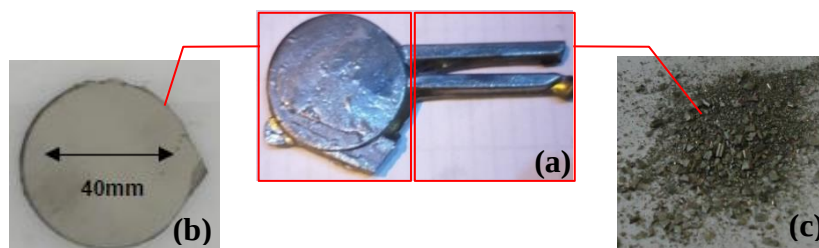
Figura 4.5 - Amostra para a determinação da análise química das amostras de fofo nodular (a) em espectrômetro de absorção atômica (b) e em espectrômetro a combustão (c).
