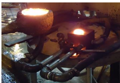
Figura 4.4 – Metal líquido retirado do forno a indução para a produção de amostras para análise química.
