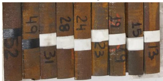
Figura 4.9 - Amostras de fofo nodular para a análise microestrutural.
