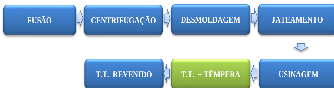
Figura 5.21 - Fluxograma padrão de produção do ferro fundido nodular martensítico.
