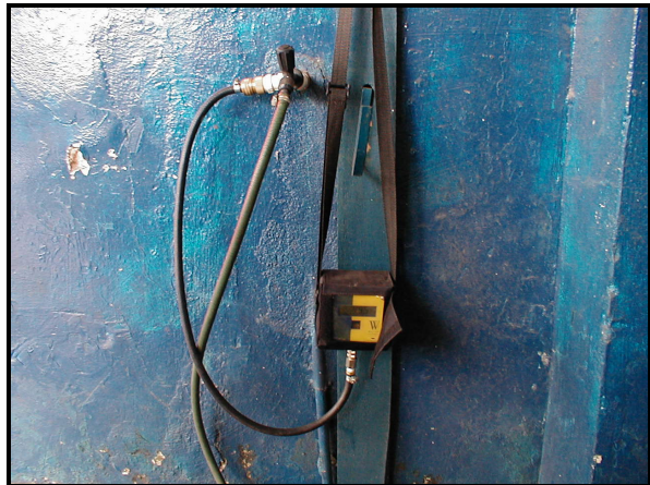
Figura 4.2- Data-Logger de pressão instalado na Rua Antônio Mariosa, nº 2145
