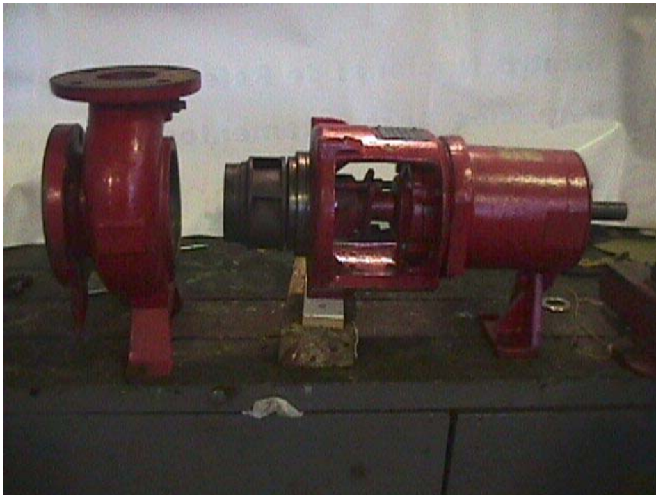
Figura II.1 – Desmontagem da bomba
