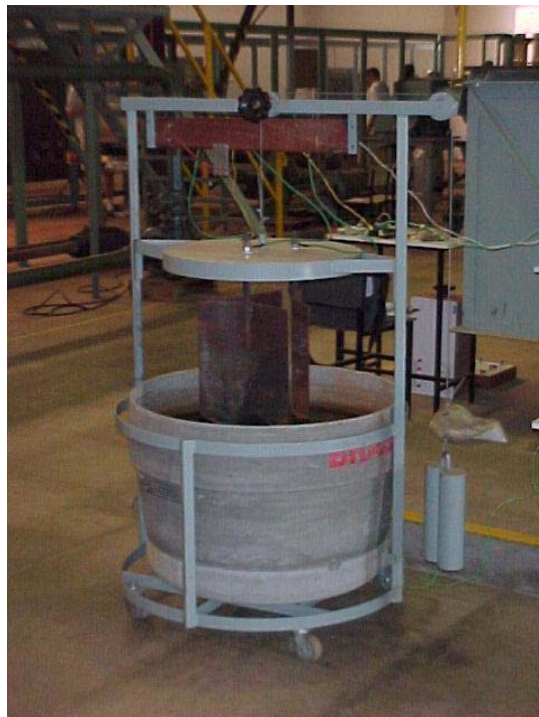
Figura III.15 – Resistência líquida para simulação da carga ativa
