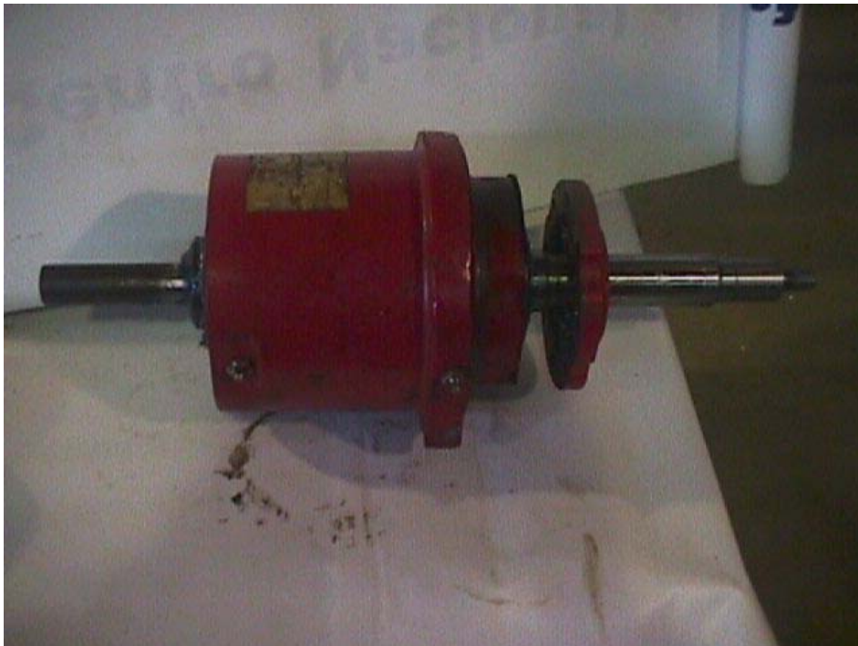
Figura II.5 – Caixa de lubrificação da bomba
