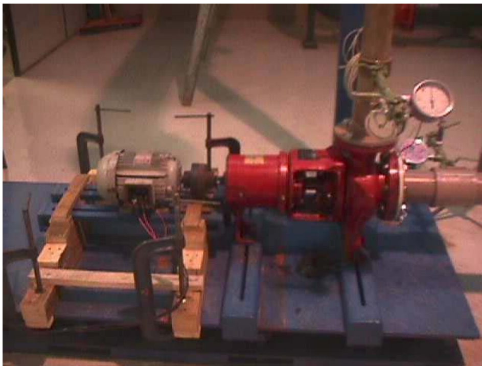
Figura III.4 – Ensaio do grupo moto-bomba – LEB
