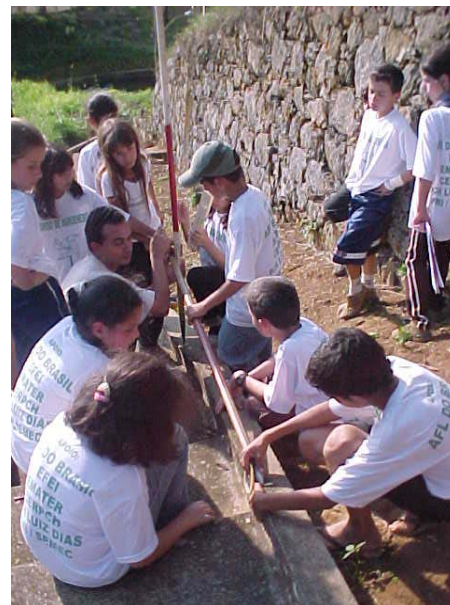
Medição de queda – método das réguas e nível de carpinteiro, 2001
