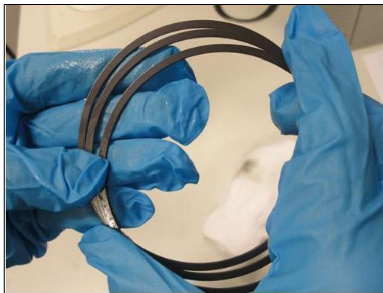
Figura 27 - Fotografia dos anéis de pistão com camada de fosfato sendo inspecionados (Fonte: AUTOR, 2022).
