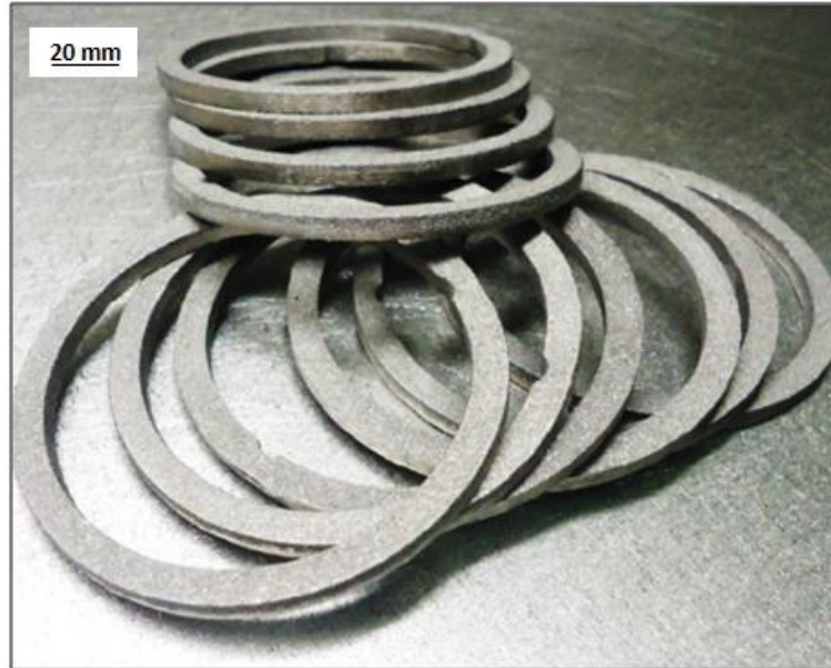
Figura 24 - Fotografia de anéis fundidos após etapas de Limpeza e Rebarbação (Fonte: AUTOR, 2022).
