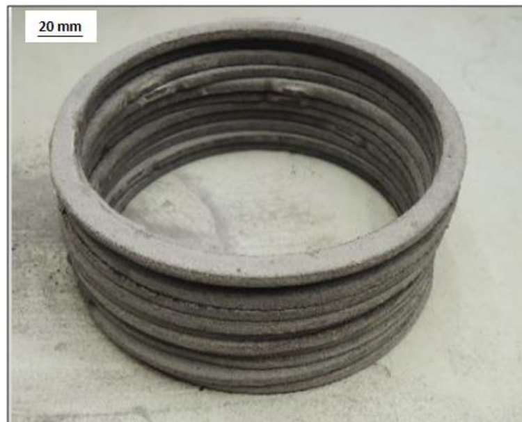
Figura 23 – Fotografia dos anéis após desmoldagem (Fonte: AUTOR, 2022).
