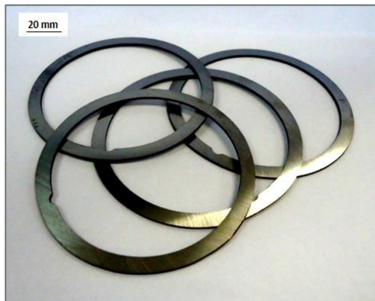
Figura 25 - Fotografia de anéis de pistão com as faces laterais retificadas (Fonte: AUTOR, 2022).
