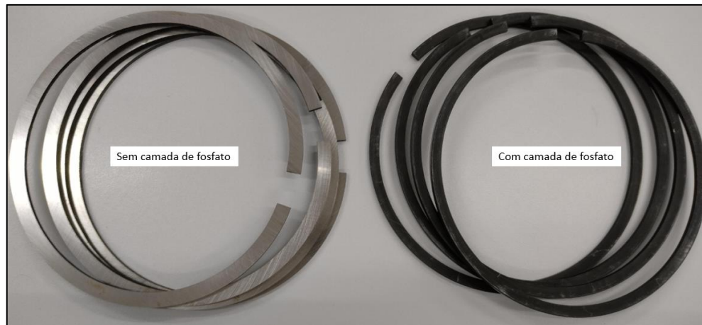
Figura 26 – Fotografia comparativa do aspecto visual entre anéis sem camada e com camada de fosfato (Fonte: AUTOR, 2022).
