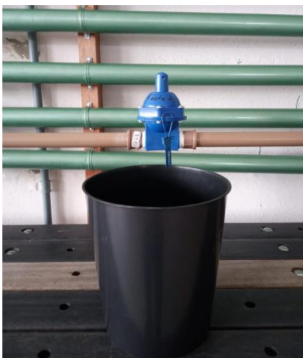
Figura 14 - Recipiente disposto abaixo do eliminador de ar.
