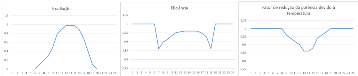
Figura 17 – Características operativas dos painéis fotovoltaicos.
