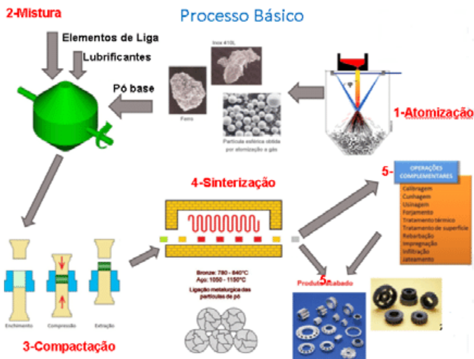
Figura 1 - Esquema representando as etapas de fabricação via metalurgia do pó
