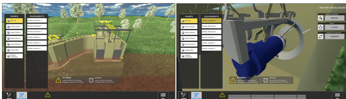
Figura 50 – Bombas submersíveis no supervisório 3D.
