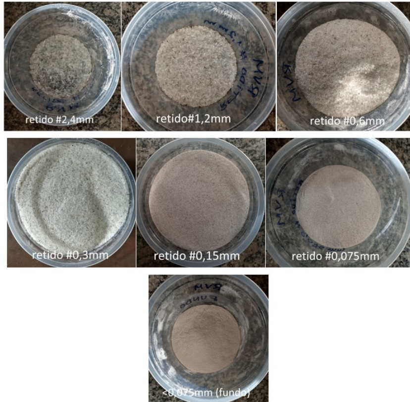
Figura 38 – RVM separado por dimensão de grãos retidos nas peneiras
