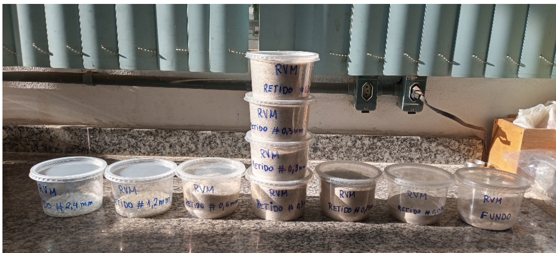
Figura 36 – RVM fino original separado em grupos por dimensão máxima de grão Fonte: próprio autor
