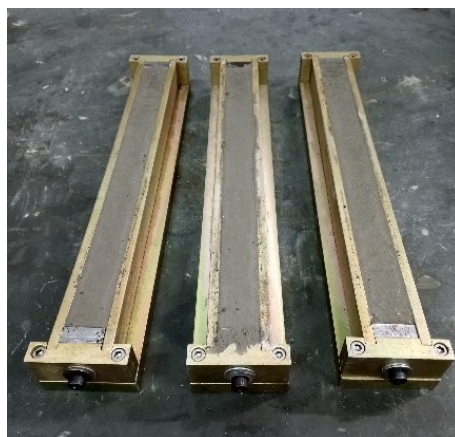
Figura 30 – Corpos de prova moldados para ensaio de ocorrência de RAA Fonte: próprio autor
