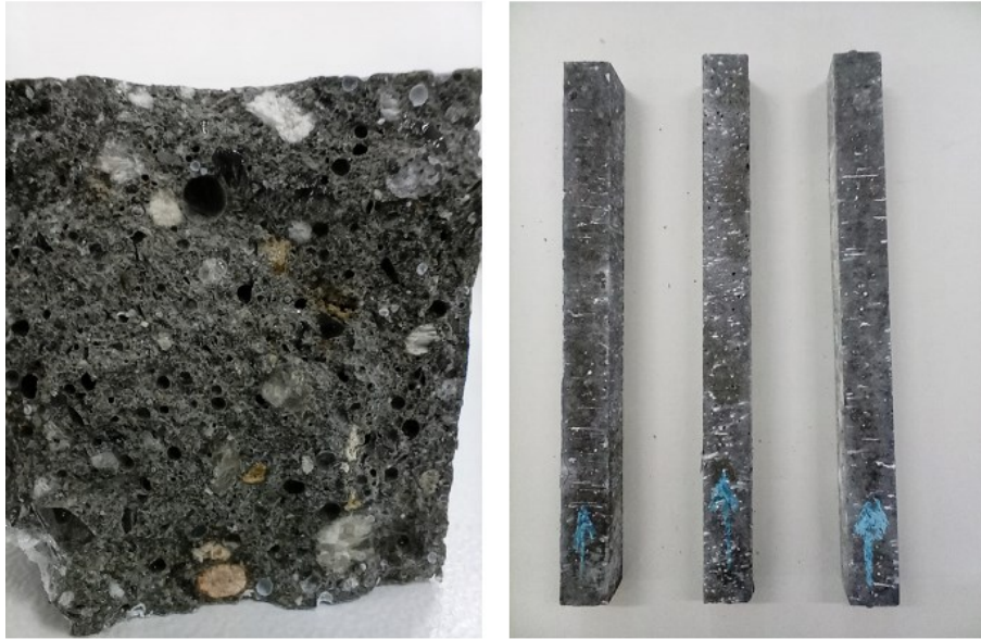
Figura 64 - Traço AAA 20 RVM: seção de barra de argamassa; barras com sinais de material esbranquiçado Fonte: próprio autor
