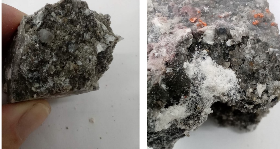
Figura 66 – Barra de argamassa convencional com 30% de substituição de areia por RVM após ensaio de expansão por RAA Fonte: próprio autor
