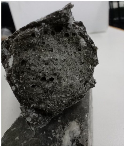
Figura 65 – barras de AAA com 30% de substituição de areia por vidro após ensaio de expansão por RAA Fonte: próprio autor
