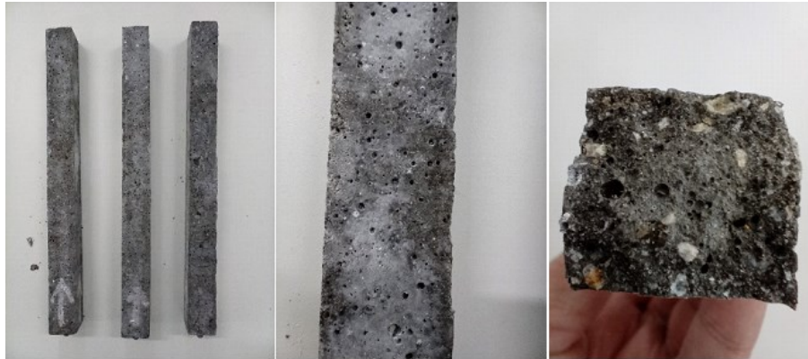
Figura 59 – Barras do traço AAA 0 RVM após ensaio de expansão Fonte: próprio autor
